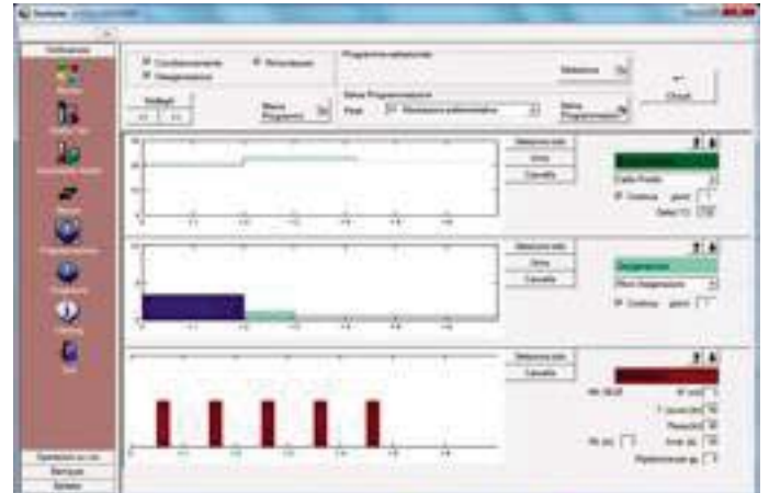
>> Pagina per la programmazione e la gestione dei parametri nel tempo; nella schermata sono rappresentati graficamente il condizionamento, l'ossigenazione ed i rimontaggi.
